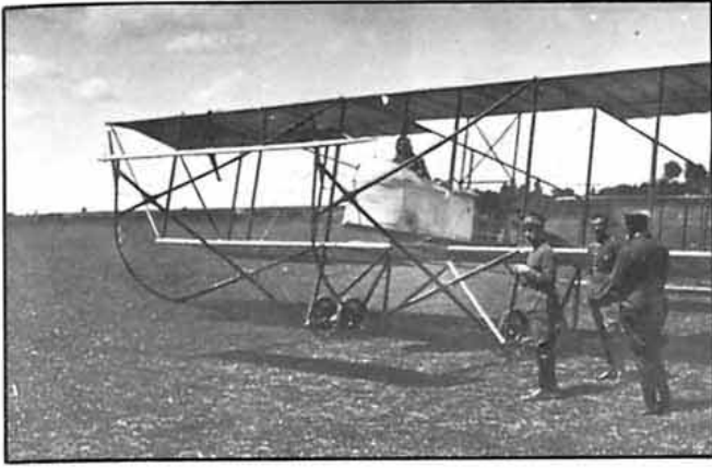
El FARMAN estaba provisto de un motor DE DION BOUTON de 8 cilindros con 80 CV de potencia.
